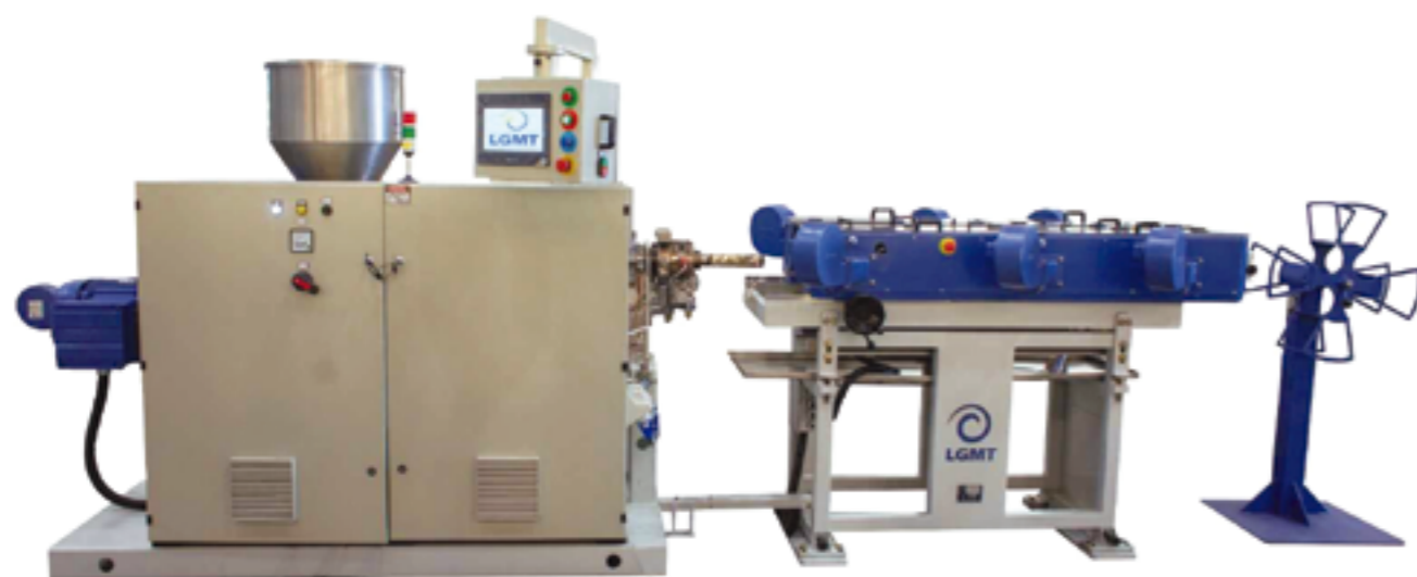
LINHA TUBOS CORRUGADOS E SIFÃO
